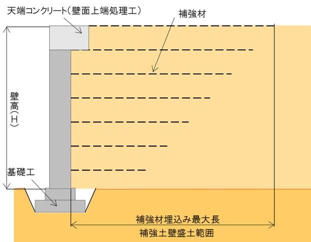
帯鋼補強土壁、アンカー補強土壁標準断面図
